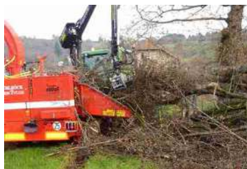
Préparation du bois avant déchiquetage : élagage des arbres, recépage modéré des arbustes. Diamètre des branches broyées : 5 à 25 cm. Gros bois à préparer à part.
